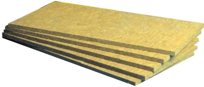
Panneau résilient en laine de roche de haute résistance mécanique pour charges d'exploitation inférieures ou égales à 500 kg/m<sup>2</sup>.
