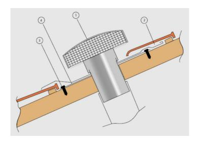
Enlever le capot pare-pluie (1)(clippé jusqu'au Ø200 et vissé au-dessus de Ø200).
