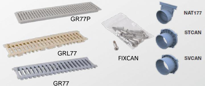
Les deux grilles PVC sont posées dans une feuillure en polypropylène de 4 mm d'épaisseur. Elles ont une largeur de fente inférieure à 20 mm, ce qui permet de respecter les exigences réglementaires liées à l'accessibilité des handicapés. Les grilles encastrées standards et légères peuvent être fixées aux caniveaux par une vis référence: FIXCAN (vendue séparément).
